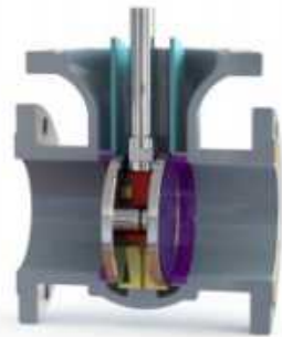
图2 阀门全关状态
